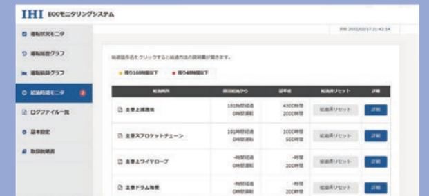
クレーンの各可動部の給油時期をカウントダウン
