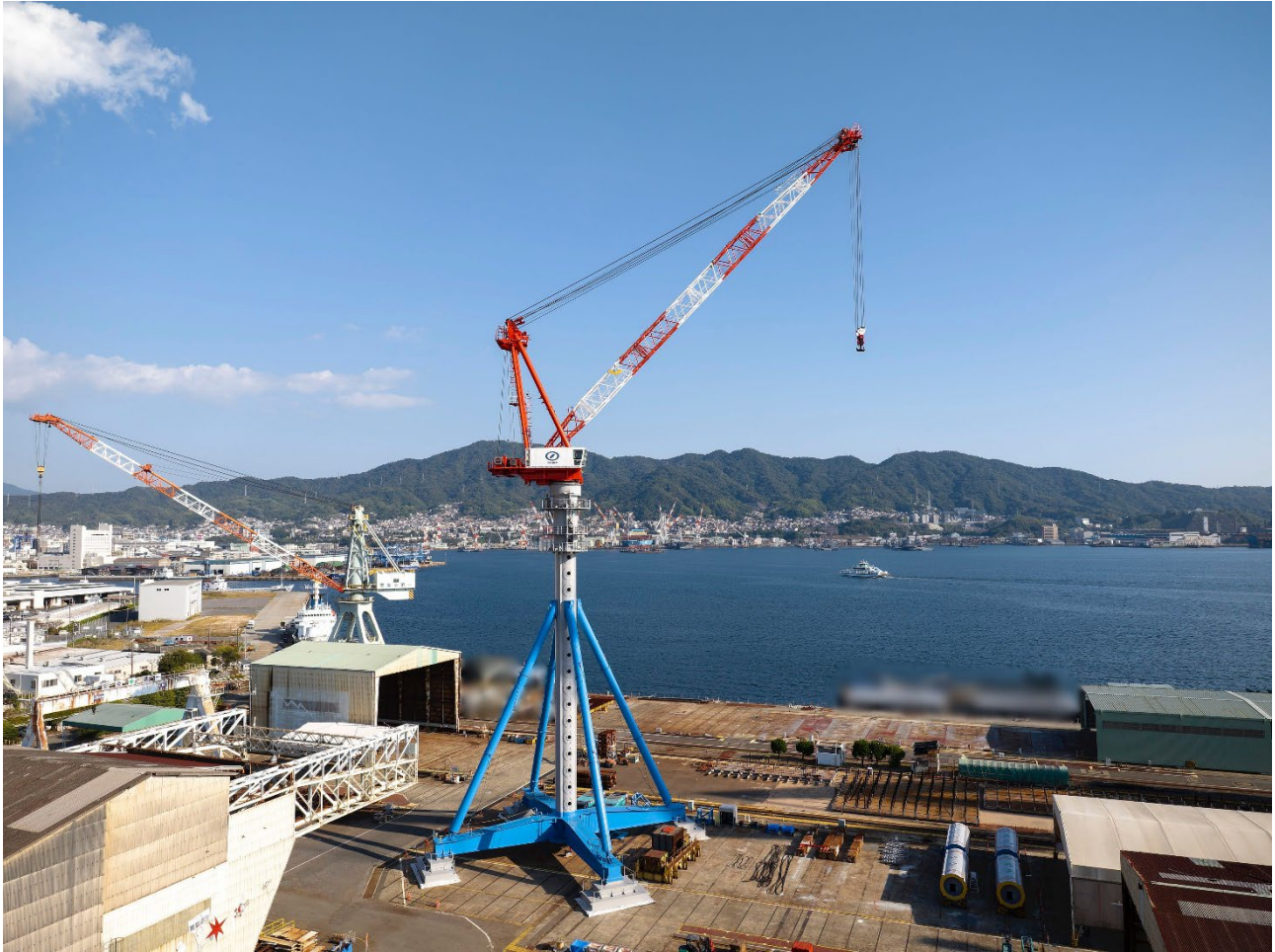
S-Movable Towercrane(マスト 37.5m 自立)
