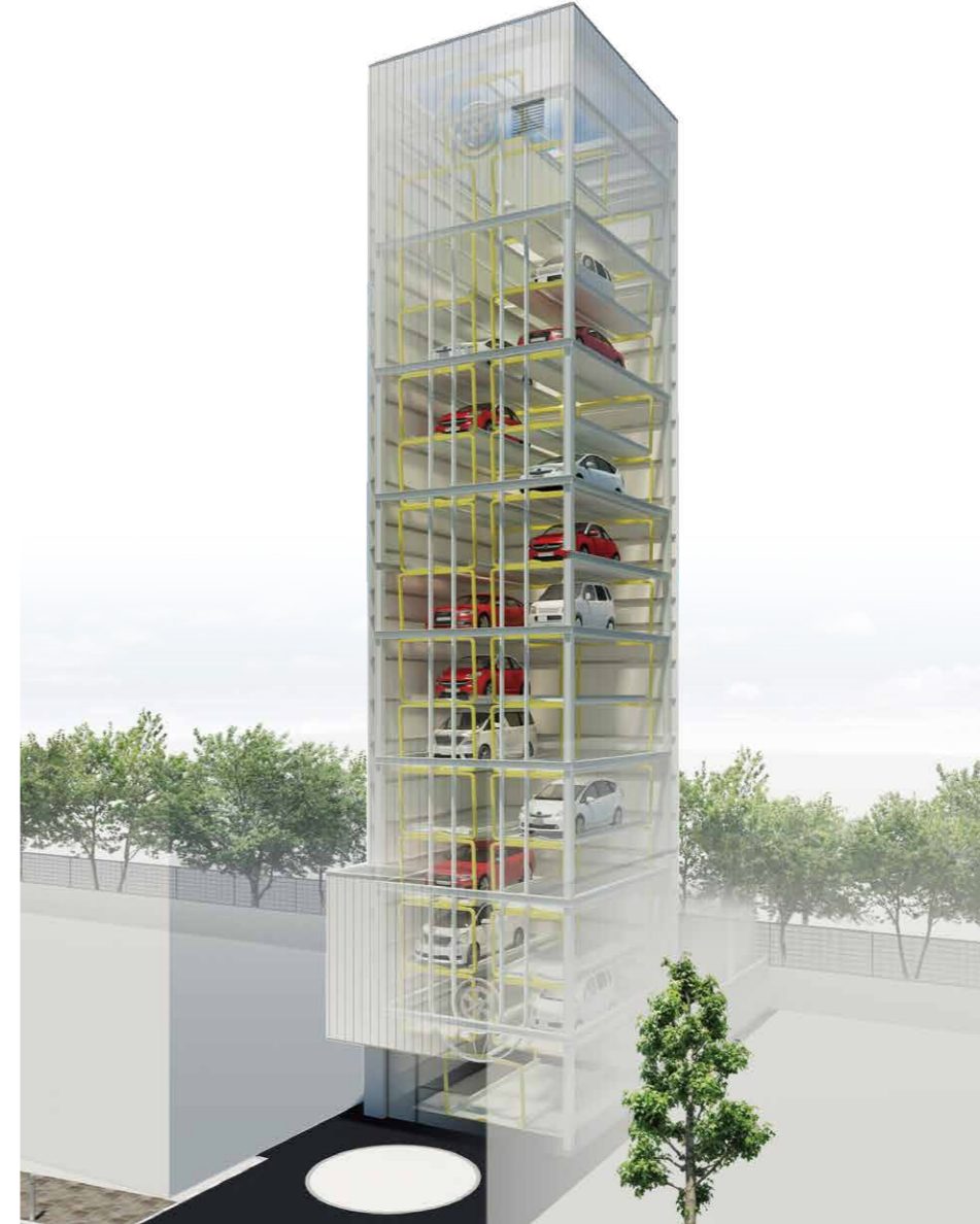
出庫時における 機械式駐車設備の動き
