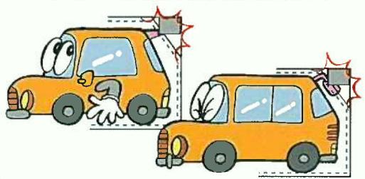
リモコンスタートを誤って押してしまい駐車装置内で車が暴走し衝突
