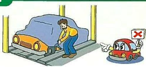
車のボディカバーを使用しないでください。外れた場合に装置作動時の障害物となり、誤作動・故障の原因となります
