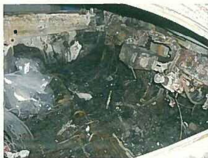
発火したエンジンルーム
