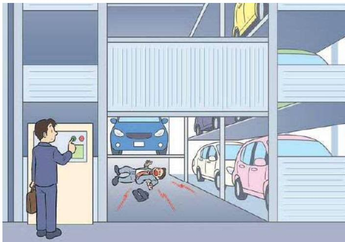
屋外設置の機械式駐車装置において、夜間、利用者が入庫操作を行ったところ、装置が異常停止した。サービス員が確認したところ、搬器と車路の間に挟まれた被災者が発見された。
