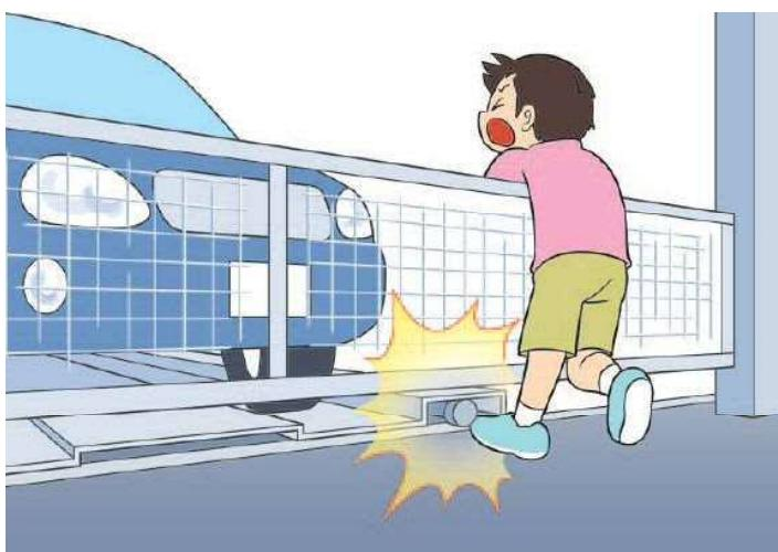
二段・多段方式の機械式駐車装置において、利用者が入庫のためパレット呼び出し操作を行ったところパレットが横行した。その際、利用者の子供が前面ゲートの下部の隙間から内側に足を入れていたため、横行するパレットのローラーに足を挟まれ重傷を負った。
