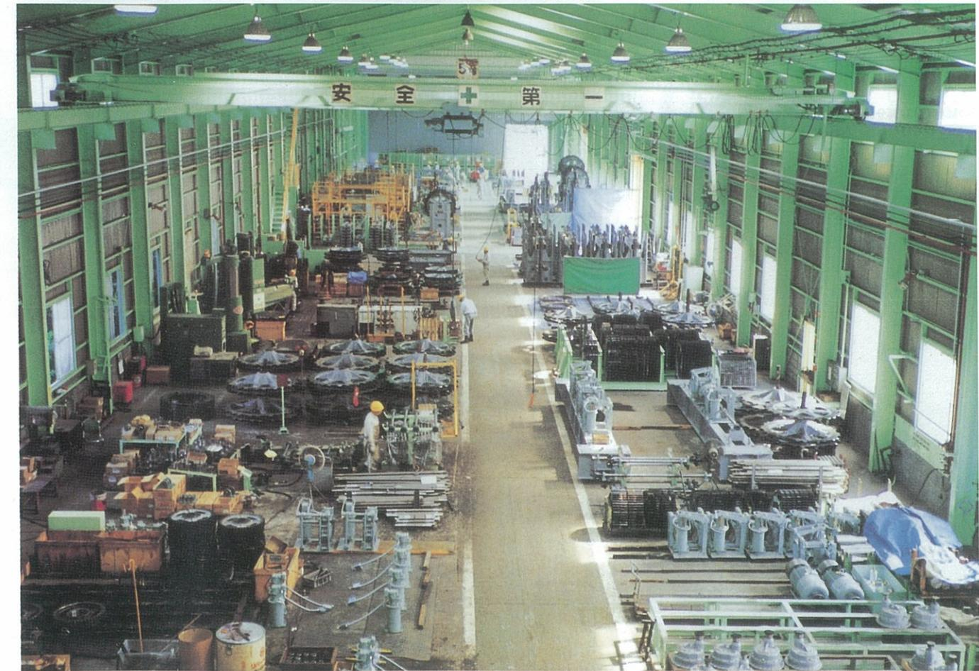
第3棟はタワーパーキングとエレベーターパーキングの駆動装置を組み立てる機械組立工場。小組立から大組立まで、各ステージごとに厳しい品質チェックを経る。大組立が完成した時点で、無負荷運転を行なって電流、電圧、回転数、速度などの計測検査と仕様検査が行なわれる。
