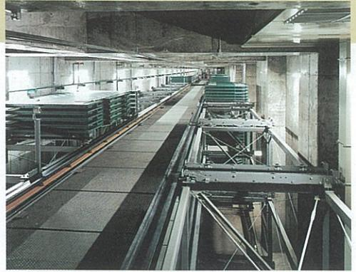
シャトルバーキング内部。中央のレーンを高速移動台車が走り、車は左右の格納棚へ収納される。
