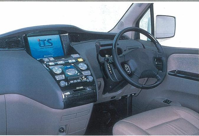
▲日産自動車が発表した近未来的コンセプトカー、ITS車の運転席。ディスプレーに道路や駐車場などの交通情報の他、レストラン、前方の障害物などの情報も表示される
