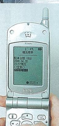
**最先端のIT（情報技術）を活用し、駐車場の「満車」「空車」情報や営業時間、料金、所在地などを、iモードの携帯電話やカーナビを通じてリアルタイムでドライバーに知らせる世界で初めての駐車場サービスが登場した。IHIなど7社の出資で事業化した「アイボスネット」のサービスだ。このシステムはまた、駐車場に設置した監視カメラやセンサーからの情報を東京の情報センターが24時間体制で一元管理し、万一、遮断バーを折って料金未納の車が不正出庫した場合などは、直ちにオーナーや警備会社に連絡したり、駐車料金の集計など駐車場の管理・運営サポートも行う画期的なものだ。この新システムにより、駐車場の集客増と運営効率アップや人件費の大幅削減が図れるものと大きな期待が寄せられている。**
