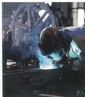
ケージ(昇降装置)の溶接作業
